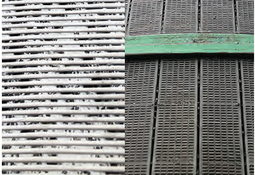
Çalışma sonrasında paslanmaz çelik ızgara ve G-Vault tank içi eleğin yan yana karşılaştırması.
