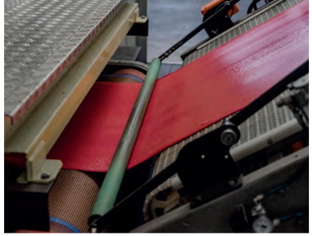
Sıvı fazlı bileşim sürecinin sonunda kauçuk, plaka üretim sürecinin bir sonraki aşaması için hazırlanır.
