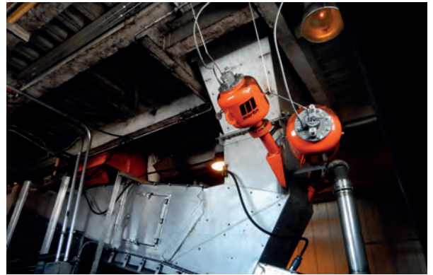
Hava şokları, malzeme birikmesini gidermek için kontrollü bir basınçlı hava patlaması sağlar.
