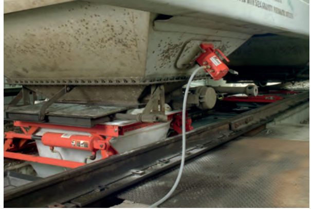
"Balyoz göçüğü" aslında çekiçlemenin üstesinden gelmeyi amaçladığı sorunu daha da kötüleştirecektir.
